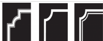
filets triple angle creux 1/2 droit et 1/2 ar filets simple angle creux arrondi filets double angle creux arrondi
